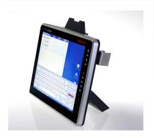
Das vier Millimeter starke Panzerglas über dem Bildschirm widersteht Säure, Reinigungs- und Desinfektionsmitteln ebenso, wie extremen mechanischen Beanspruchungen. Hinter dem Glas befindet sich das projektive, kapazitive Touch-Panel. Eine spezielle Empfindlichkeitsregelung ermöglicht eine zuverlässige Gestensteuerung - und dies sogar mit Handschuhen.
