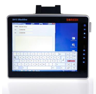
Die hochleistungsfähigen Industrie-Computer der Baureihe SH **Blackline Core i7**, nach der Bildschirmgröße SH12, SH15 und SH21, bieten hochsensitive Multitouch-Technologie hinter Sicherheitsglas.
